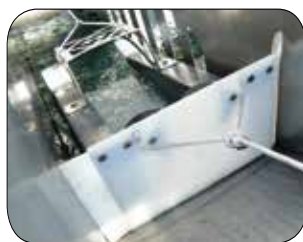
Raschiatore grassi con limitata eliminazione di acqua
