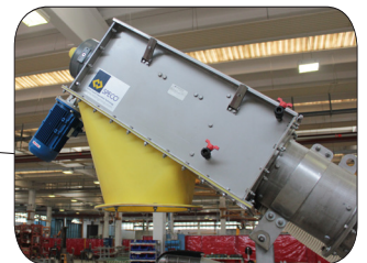
Polymer-Auslauf mit Kompaktier- und Waschsystem
