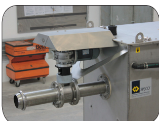
Schnellanschlusskupplung und Perrot Ventil
